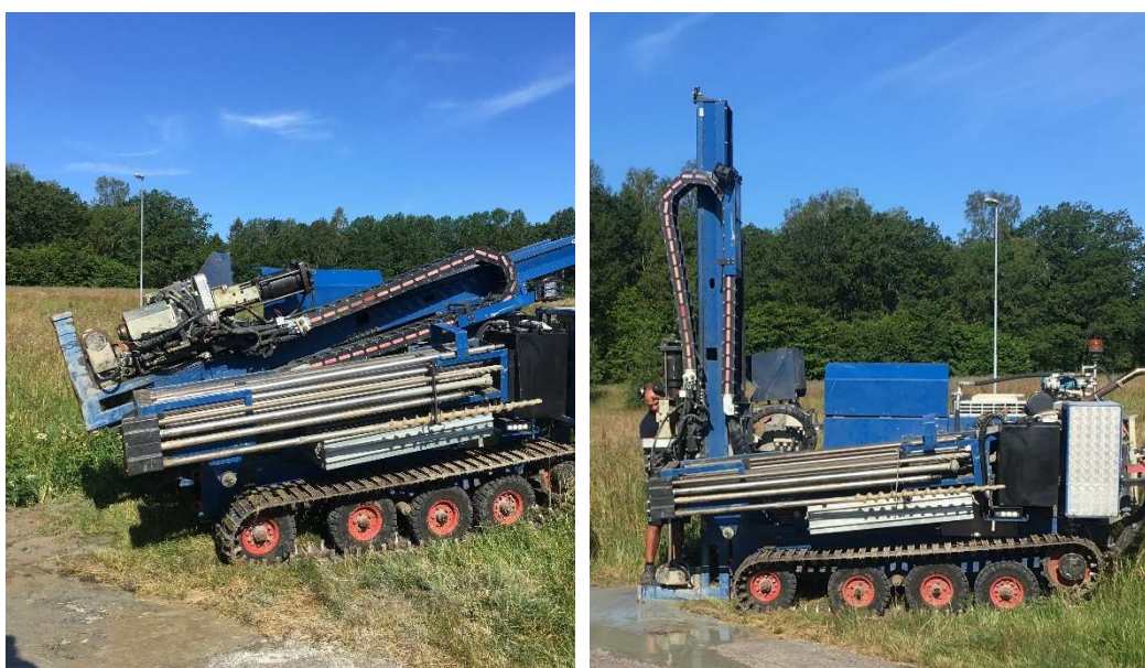
Figur 1 Exempel på en borrarbandvagn som används vid geotekniska fältundersökningar.
